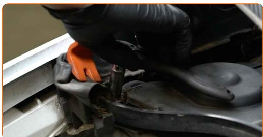
**7** Odstranite zaščitni pokrovček z nosilca opornika amortizerja.
