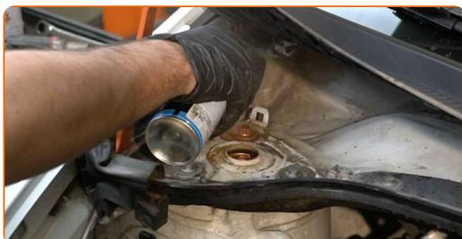
**62** Namestite zaščitni pokrovček z nosilca opornika amortizerja.
