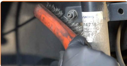
**16** Odvijte pritrdilni element, ki povezuje jarmov drog na blažilnik. Uporabite nasadni ključ №16. Uporabite izvijač z zatikalom.
