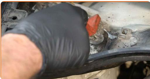
**9** Sprostite zgornji pritrdilni element sedeža za namestitev blažilnika. Uporabite nasadni ključ №13. Uporabite izvijač z zatikalom.
