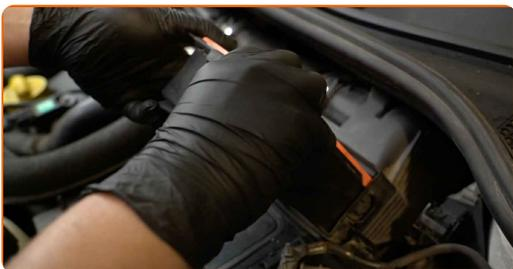
**6** Očistite pokrov zračnega filtra in ohišje.
