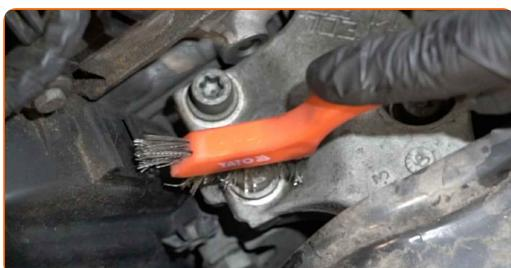
8 Odvijte pritrdilne elemente, ki povezujejo nosilec motorja s karoserijo. Uporabite nasadni ključ №E14. Uporabite izvijač z zatikalom.
