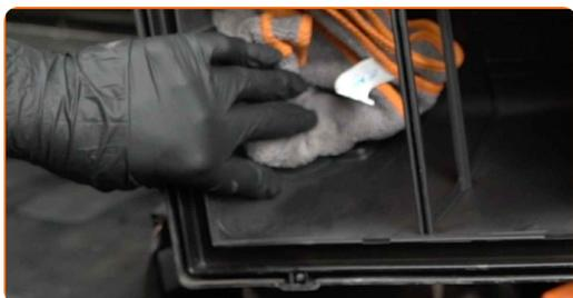
7 Očistite pokrov zračnega filtra in ohišje.
