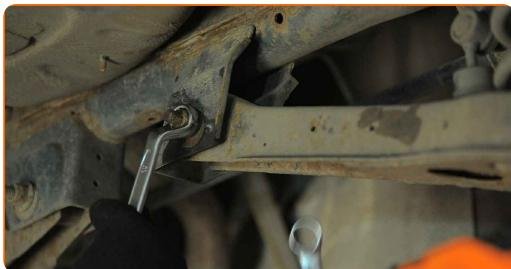
**8** Očistite pritrdilne elemente opornikov stabilizatorja. Uporabite žično krtačo. Uporabite sprej WD-40.
