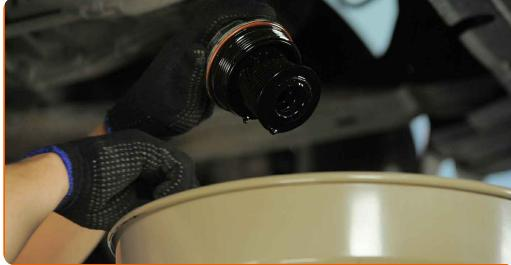
14 Očistite pokrov ohišja oljnega filtra. Uporabite večnamenski čistilni sprej.
