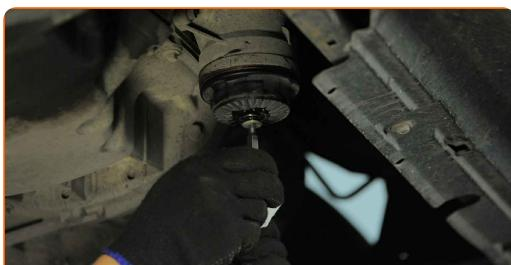
11 Odvijte ohišje pokrova filtra skupaj s starim elementom filtra. Uporabite natični ključ 65/14F. Uporabite izvijač z zatikalom.
