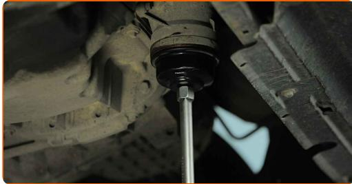
12 Odložite stari oljni filter v posodo.
