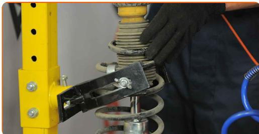
**54** Namestite zgornji nosilec opornika in ležaj nosilca opornika. Uporabite imbus št. H5.
