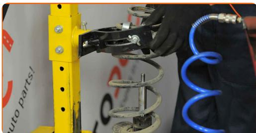
**49** Odstranite stari amortizer s kompresorja hidravlične spiralne vzmeti.
