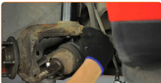
**24** Odvijte spodnji pritrdilni element, ki povezuje blažilnik s premnikom. Uporabite nasadni ključ №15. Uporabite izvijač z zatikalom.
