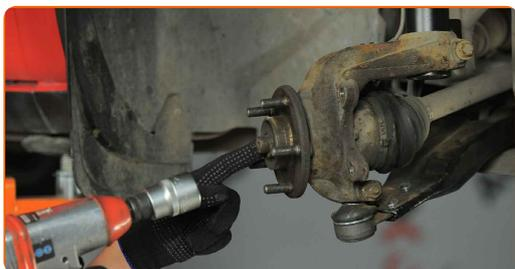
**13** Odvijte pritrdilni element pogonske gredi na pesto kolesa. Uporabite nasadni ključ №32. Uporabite izvijač z zatikalom.
