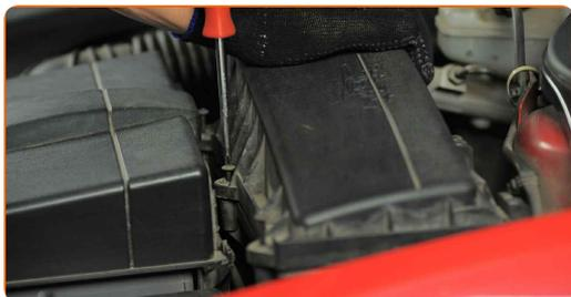
**12** Priključite dovodno cev zraka na ohišje zračnega filtra.
