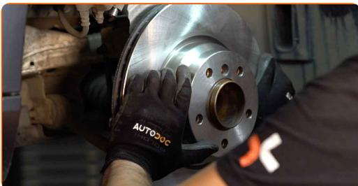
**24** Zategnite pritrditve zavornega diska. Uporabite imbus št. H5. Uporabite navorni ključ. Zategnite ga do navora 16 Nm.
