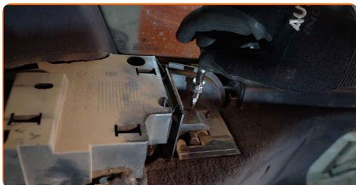
**9.1** Odvijte pritrdilne elemente panela z zračnikom v prtlačniku.
