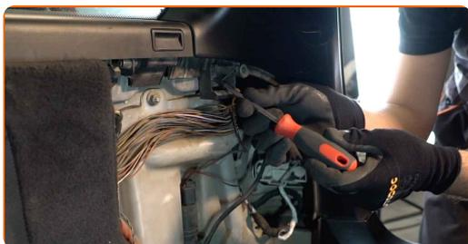
**10** Odvijte pritrdilne elemente sprednje obloge prtlačnika. Uporabite Phillips križni izvijač.
