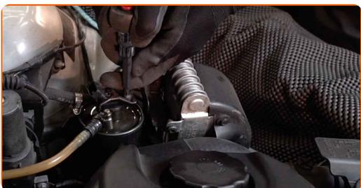
**6** Odstranite senzor za tlak goriva.
