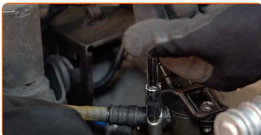
**4** Odstranite priključek senzorja za tlak goriva.
