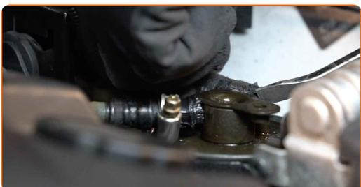
**8** Odvijte nosilec filtra za gorivo. Uporabite vijačni nastavek T30. Uporabite izvijač z zatikalom.
