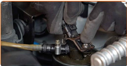
**5** Odvijte pritrdilni element senzorja za tlak goriva. Uporabite vijačni nastavek T30.
