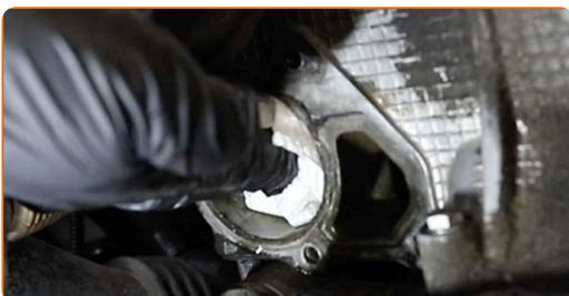
**37** Očistite vgradni prostor ohišja termostata. Uporabite strgalo za tesnilo. Uporabite večnamenski čistilni sprej.
