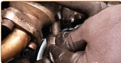
52 Pritrdite sponko cevi hladilne tekočine. Uporabite nasadni ključ №7. Uporabite izvijač z zatikalom.
