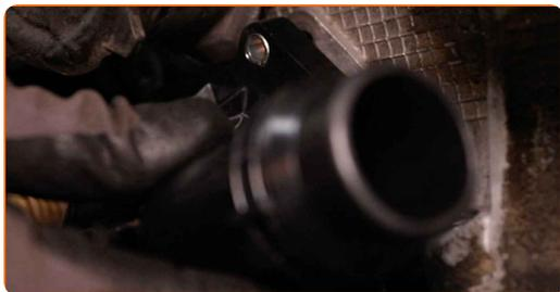
**41** Zategnite pritrdilne elemente ohišja termostata. Uporabite nasadni ključ N°10. Uporabite navorni ključ. Zategnite ga do navora 9 Nm.
