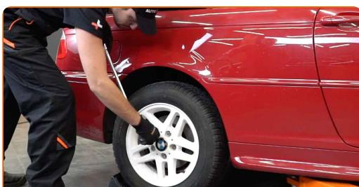
**7** Vzdignite zadnji del avtomobila in otrdite podpornike.
