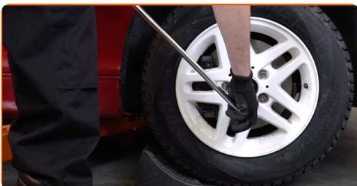
4 Vzdvignite sprednji del avtomobila in otdrite podpornike.
