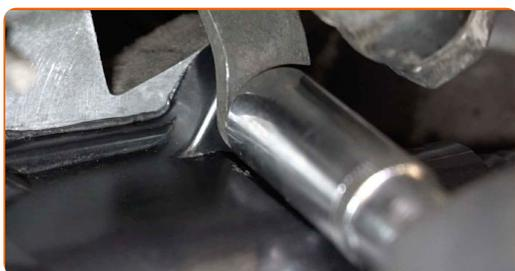
**40** Zategnite pritrdilne elemente ohišja termostata. Uporabite nasadni ključ №10. Uporabite navorni ključ. Zategnite ga do navora 7 Nm.
