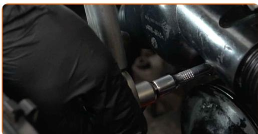
**41** Očistite pritrdilne elemente ohišja termostata. Uporabite večnamenski čistilni sprej.
