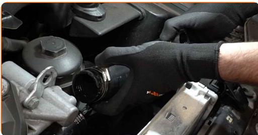
**12** Odvijte sponko cevi hladilne tekočine. Uporabite nasadni ključ №7. Uporabite izvijač z zatikalom.
