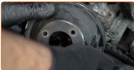
**24** Očistite vgradni položaj vodne črpalke. Uporabite žično krtačo. Uporabite večnamenski čistilni sprej.
