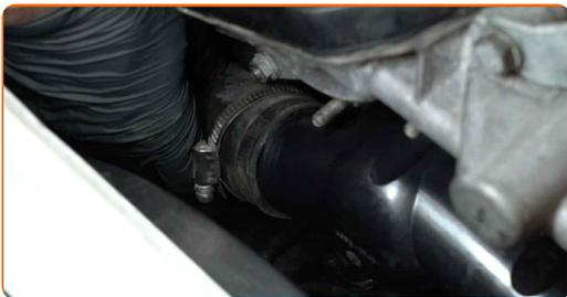
**43** Pritrdite sponke cevi hladilne tekočine. Uporabite nasadni ključ N°7. Uporabite izvijač z zatikalom.
