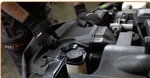
**55** Namestite pritrdilne elemente ohišja zračnega kanala.
