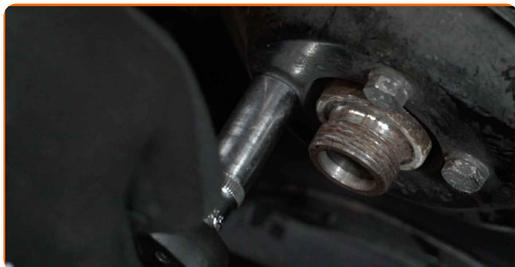
**20** Odmaknite napenjalni valj rebrastega jermena. Uporabite nasadni ključ №16. Uporabite izvijač z zatikalom.
