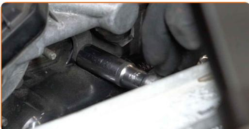
**15** Odvijte pritrdilne elemente ohišja termostata. Uporabite nasadni ključ №10. Uporabite izvijač z zatikalom.
