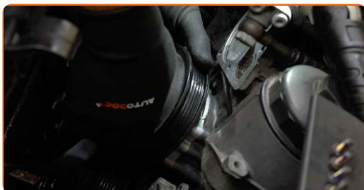
**32** Privijte pritrdilne elemente jermenice vodne črpalke. Uporabite nasadni ključ №10. Uporabite izvijač z zatikalom.
