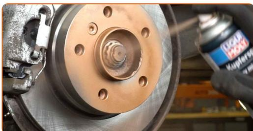
**34** Očistite površino zavornih kolutov. Uporabite čistilo zavor.
