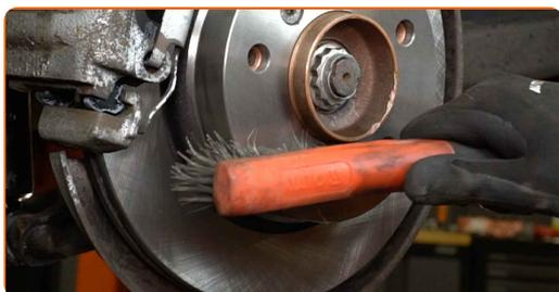
**33** Obdelajte površino, kjer se zavorni kolut stika s platiščem. Uporabite bakreno mast.
