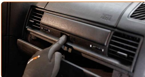
**3** Odvijte pritrtilne vijke predla pred sovoznikom. Uporabite Phillips križni izvijač. Uporabite ploščat izvijač.
