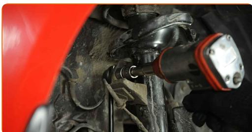
**8** Odstranite nosilec kabelskega snopa ABS.
