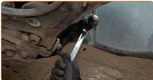
8 Odvijte pritrdilni element, ki povezuje drog stabilizatorja z vzemtno nogo. Uporabite nasadni ključ №18. Uporabite izvijač z zatikalom.
