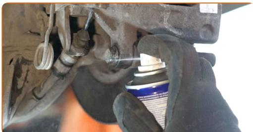
8 Odvijte pritrditve zavorne čeljusti. Uporabite kombinirani ključ №19. Uporabite nasadni ključ №13. Uporabite izvijač z zatikalom.
