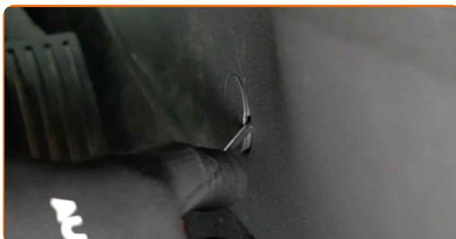
**2** Odvijte pritrdilne elemente stranskega plastičnega okrasnega panela. Uporabite vijačni nastavek T20.
