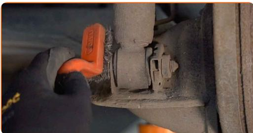
**11** Odvijte spodnjo pritrditev opornika amortizerja. Uporabite nasadni ključ №18. Uporabite udarni nasadni ključ.
