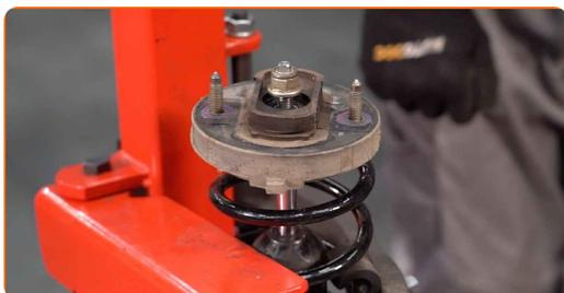
29 Zategnite matico amortizerja. Uporabite nasadni ključ za blažilnik DDN<sup>®</sup>6,3. Uporabite nasadni ključ №17. Uporabite navorni ključ. Zategnite ga do navora 45 Nm.
