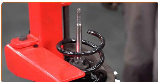
28 Namestite zgornji nosilec opornika in ležaj nosilca opornika.
