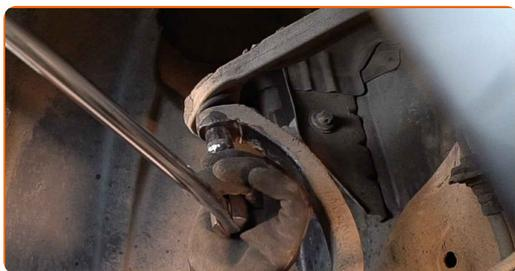
**22** Odklopite zglob od volanskega členek. Uporabite snemalec nosilnega zgiba.
