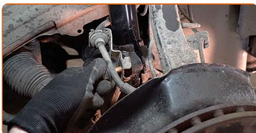
**42** Podprite ročico. Uporabite dvigalko s hidravličnim prenosom.
