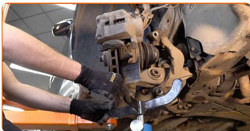
**21** Odvijte pritrdilne elemente nosilnega zgiba. Uporabite nasadni ključ №16. Uporabite izvijač z zatikalom.
