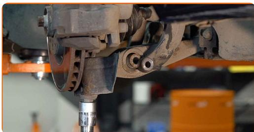
**43** Privijte pritrdilni element, ki povezuje roke amortizerja s spodnjim vilicami. Uporabite nasadni ključ №21. Uporabite udarni nasadni ključ.
