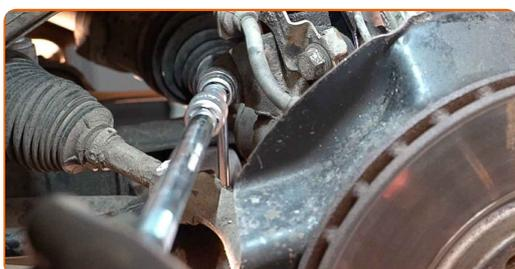
**48** Obdelajte vse dele prečnega vodila. Obdelajte pritrdilne elemente blažilnika. Uporabite bakreno mast.
