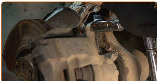
**45** Zategnite pritrdilni element, ki povezuje roke amortizerja s spodnjimi vilicami. Uporabite nasadni ključ №21. Uporabite navorni ključ. Zategnite ga do navora 55 Nm.+45°
