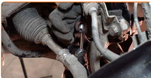
**47** Zategnite pritrdilni element, ki povezuje drog stabilizatorja z rokami amortizerja. Uporabite kombinirani ključ №18. Uporabite imbus št. H6. Uporabite navorni ključ. Zategnite ga do navora 60 Nm.
