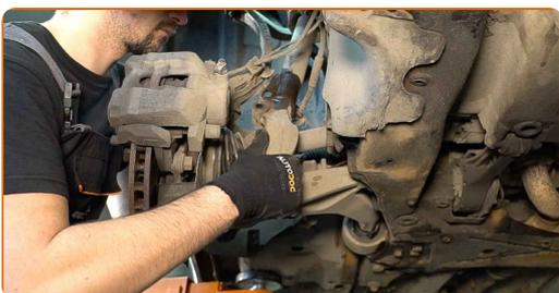
**18** Odvijte pritrdilne elemente na vrhu nosilca amortizerja.
