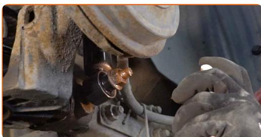
**33** Očistite nosilec platišča kolesa. Uporabite žično krtačo. Obdelajte kontaktno površino. Uporabite bakreno mast.
