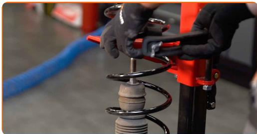
**40** Namestite zgornji nosilec opornika in ležaj nosilca opornika.
