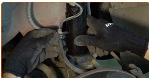
**58** Pritrdite spodnje pritrdilne elemente, ki povezujejo blažilnik in premnik. Uporabite nasadni ključ №16. Uporabite navorni ključ. Zategnite ga do navora 59 Nm.
