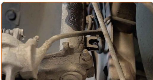
**15** Odvijte pritrdilni element, ki povezuje jarmov drog na blažilnik. Uporabite kombinirani ključ №17. Uporabite vijačni nastavek T30. Uporabite izvijač z zatikalom.
