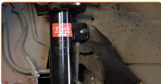
**56** Zategnite pritrdilni element veznega elementa stabilizatorja. Uporabite nasadni ključ №17.
