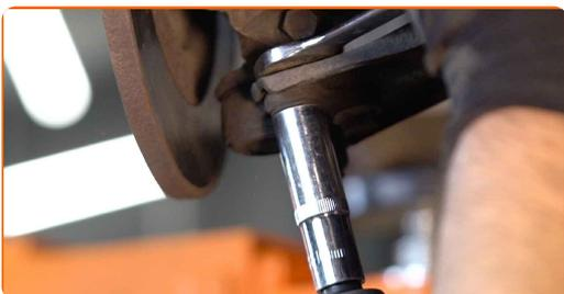
**55** Namestite prečno povezavo stabilizatorja.
