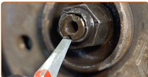
**9** Sprostite pritrdilni element pogonske gredi. Uporabite nasadni ključ №30. Uporabite udarni nasadni ključ.
