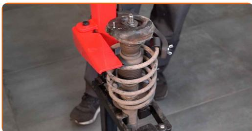
**32** Odstranite matico oporne batnice. Uporabite nasadni ključ №19. Uporabite imbus št. H7. Uporabite izvijač z zatikalom.
