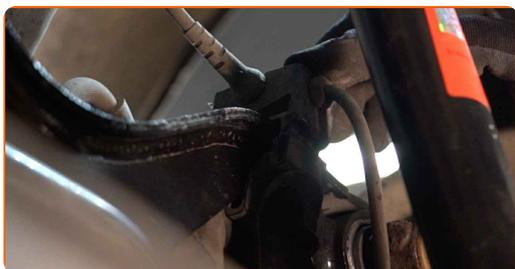
**36** Obdelajte vse dele prečnega vodila. Uporabite bakreno mast.
