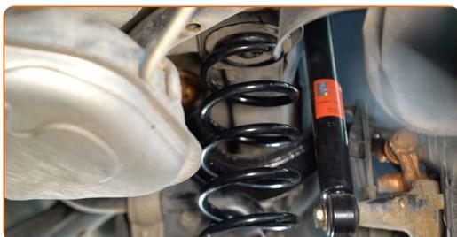
**38** Očistite nosilce in ležaje prečnega vodila. Uporabite žično krtačo. Uporabite sprej WD-40.
