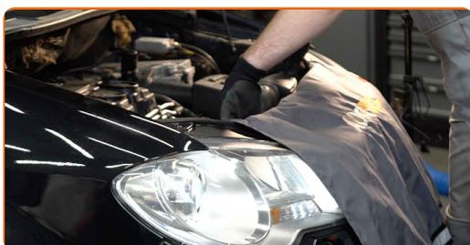
3 Odstranite pritrdilne vijake pokrova zračnega filtra. Uporabite Phillips križni izvijač.
