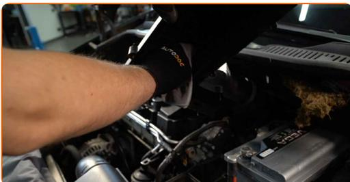
7 Očistite pokrov zračnega filtra in ohišje.
