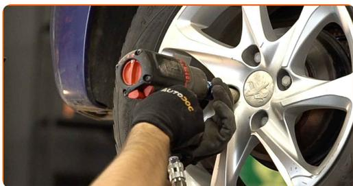
**22** Spustite avto in z delanjem v navzkrižnem vrstnem redu, zategnite kolesne vijake. Uporabite navorni ključ. Zategnite ga do navora 100 Nm.
