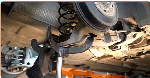
**16** Pritrdite spodnjo pritrditev amortizerja. Uporabite nasadni ključ N°E12. Uporabite navorni ključ. Zategnite ga do navora 100 Nm.
