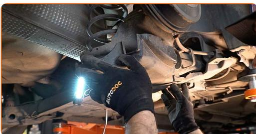
**19** Očistite nosilec platišča kolesa. Uporabite žično krtačo. Obdelajte kontaktno površino. Uporabite bakreno mast.
