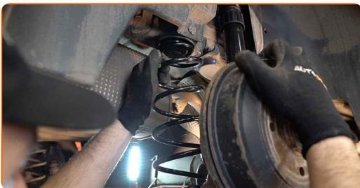
**15** Podprite zadnji nosilec vzmetenja. Uporabite dvigalko s hidravličnim prenosom.
