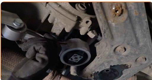
**11** Privijte pritrdilni element za pritrditev motorja, ki ga povezuje s pomožnim okvirjem. Uporabite nasadni ključ №16.
