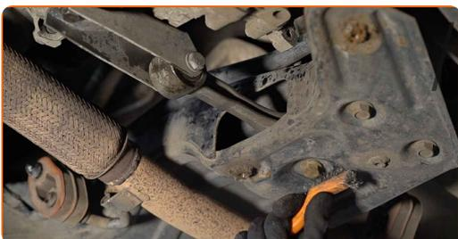
7 Odvijte pritrdilni element, ki povezuje pritrnitev motorja in ohišje menjalnika. Uporabite nasadni ključ N°16. Uporabite izvijač z zatikalom.
