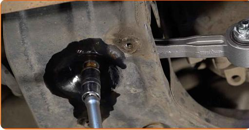
**12** Privijte pritrdilni element za pritrditev motorja, ki ga povezuje z ohišjem menjalnika. Uporabite nasadni ključ №16. Uporabite izvijač z zatikalom.
