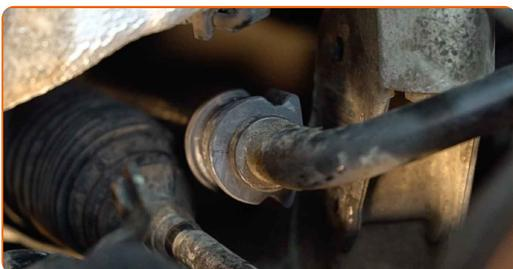
14 Namestite nosilce puš stabilizatorja.
