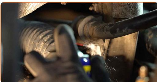
7 Odvijte pritrdilne elemente nosilcev puš stabilizatorja. Uporabite kombinirani ključ №13.
