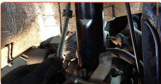
10 Spustite hidravlično dvigalo za menjalnik za 10-15 cm.
